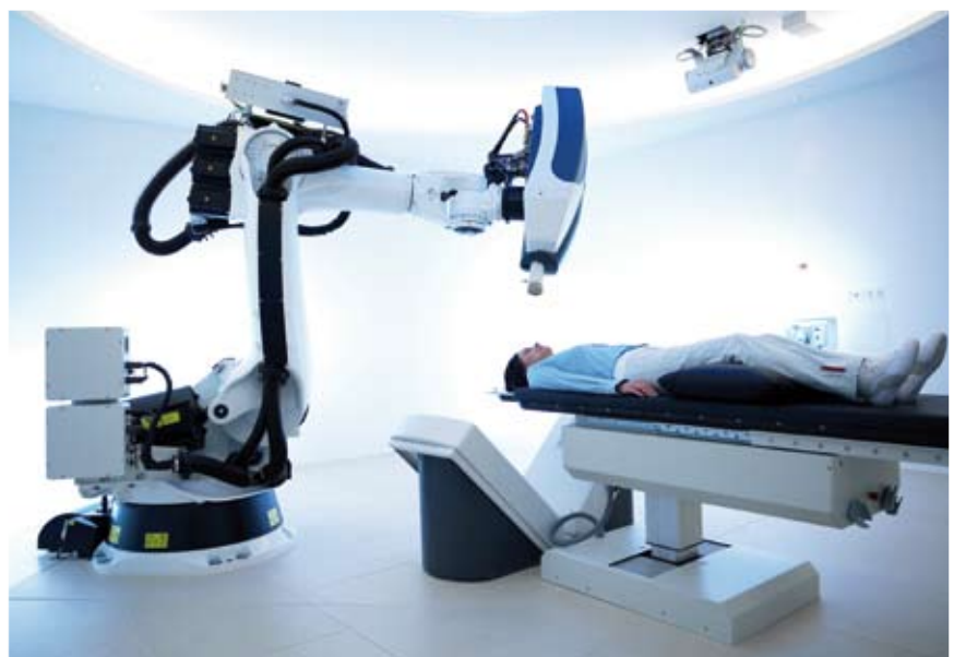
Abb. 1 Cyberknife-System mit Behandlungstisch, Röntgendektoren, an der Decke befestigten Röntgenröhren, Roboter und Linearbeschleuniger (LINAC).
